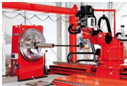
▲ Laserbeschichten einer inneren Oberfläche eines Rohres.
