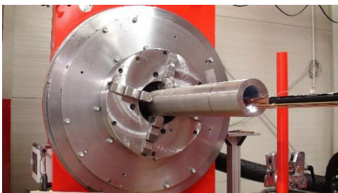
Innenbeschichten mit NUTECH Innenbearbeitungsoptik
